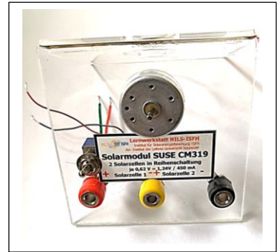
Einbau von Typschild, Buchsen mit Lötösen und Schalter
