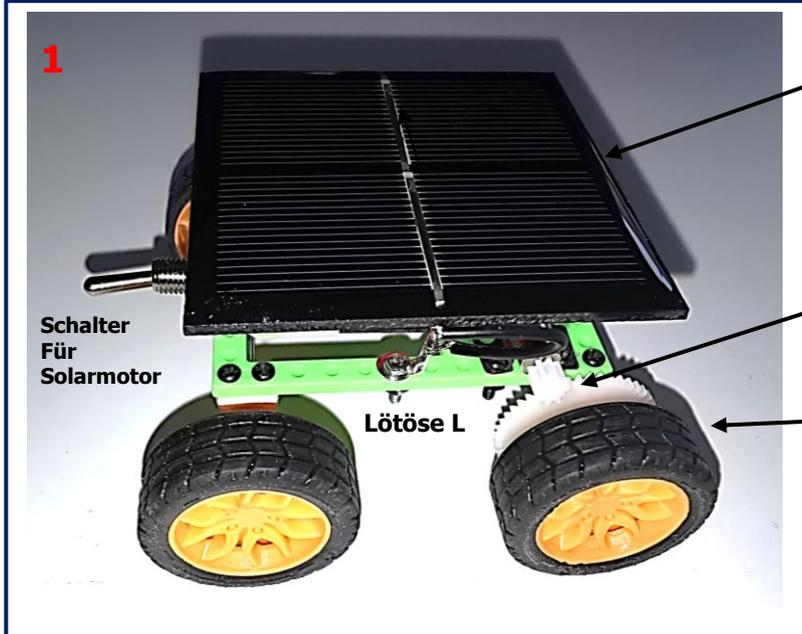
**Solarmodul 60mm x 60mm mit 2 Solarzellen in interner Reihenschaltung**
