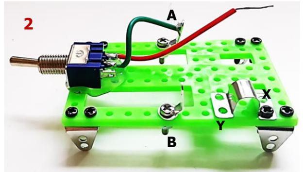
**Montage der 2 Lötösen A + B (siehe Foto 2!)** Jeweils in das 6. Loch am Rande des grünen Trägers wird eine Lötöse aufgelegt, von oben eine kleine silberne Schraube M2 durchgesteckt und von unten eine silberne Mutter aufgedreht, Schraube fest anziehen, die Lötösen zeigen nach vorne und werden senkrecht hochgebogen. Abschließend wird das blanke Ende des grünen Drahtes vom Schalter in die Lötöse A gesteckt.
