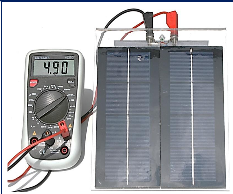
Oben: Das Solarmodul SUSE 4.35, auf der Vorderseite befinden sich 2 Module SUSEmod6, auf der Rückseite erkennt man die 2 Buchsen rot (+) und schwarz (-), dazwischen die grüne LED zur Betriebsanzeige. Das Voltmeter zeigt die Modulspannung 4,9 V an.
