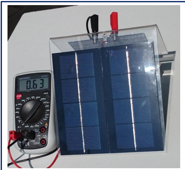
Oben: Das Solarmodul SUSE 4.35, auf der Vorderseite befinden sich 2 Module SUSEmod6, auf der Rückseite erkennt man die 2 Buchsen rot (+) und schwarz (-), dazwischen die grüne LED zur Betriebsanzeige. Das Voltmeter zeigt die Modulspannung 4,9 V an.
