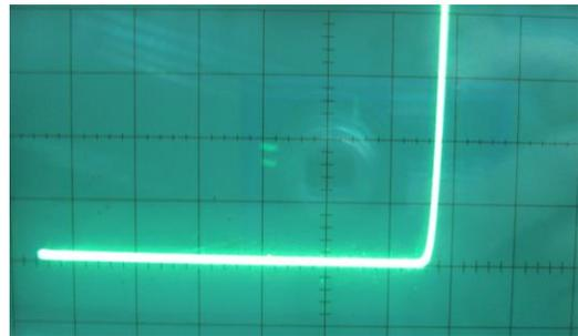
Oszilloskopbild der I-U-Kennlinie der rot leuchtenden LED
