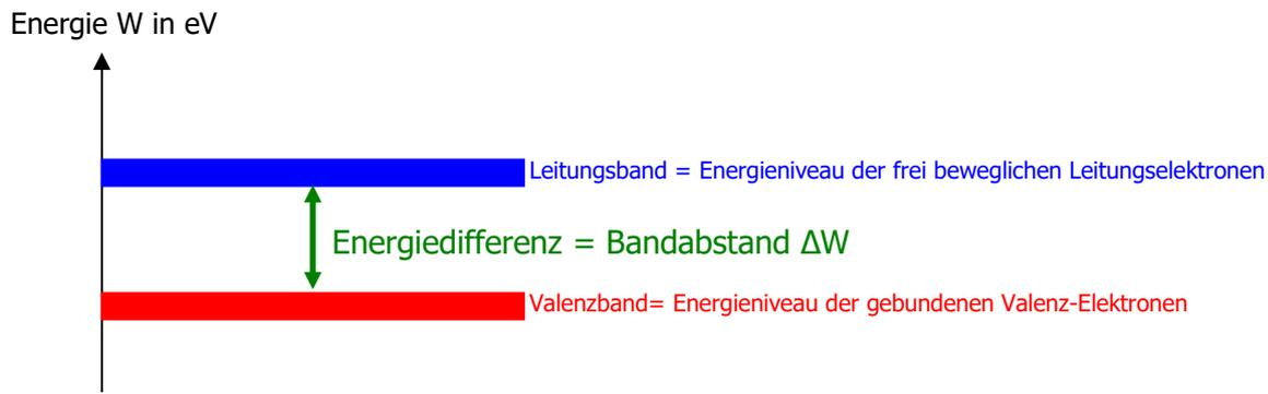
Diese **Energiedifferenz  $\Delta W = \text{Bandabstand}$**  ist materialabhängig, **bei Silizium beträgt der Wert 1,1 eV.**
