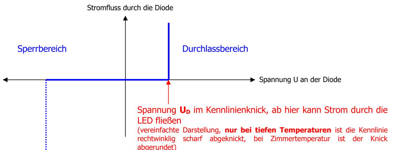
Im Bereich der negativen Spannung bis hin zur Driftspannung  $U_D$ , im waagerechten Teil der Kennlinie ist im Idealfall der innere Widerstand der LED unendlich groß, sie leitet den Strom nicht. Im Bereich der vertikalen Kennlinie oberhalb  $U_D$  ist der innere Widerstand im Idealfall 0, die LED leitet den Strom sehr gut. Daher kann an der Diode die Spannung im Idealfall auch nie höher werden als  $U_D$ . Daher darf eine LED auch nur mit Vorwiderstand R betrieben werden, sonst würde
