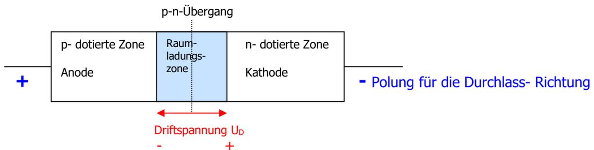
Bereits bei der Herstellung der LED entsteht – wie bei jeder Diode- durch Diffusion von Löchern in das n- Gebiet und von Elektronen in das p- Gebiet eine ladungsträgerfreie Raumladungszone, das in ihr entstandene innere elektrische Feld hat die Drift- Spannung  $U_D$ , mit dem Minuspol auf der p- dotierten Seite und dem Pluspol auf der n- dotierten Seite.
