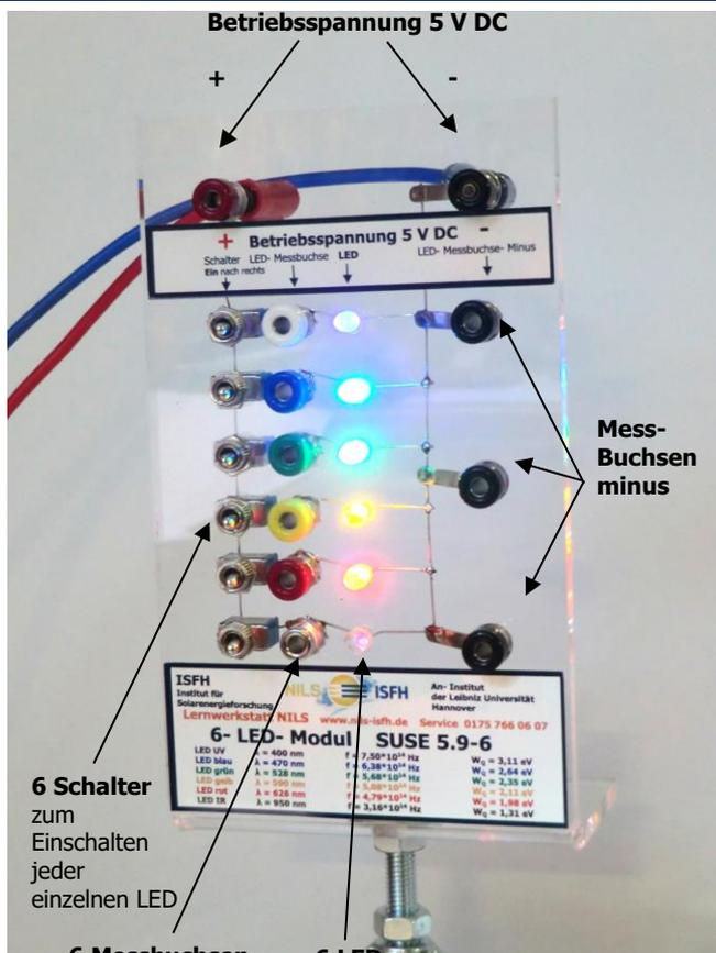
Das **6- LED- Modul SUSE 5.9-6** ist für Experimente zur **Licht- Emission** und zur **Licht – Absorption** geeignet, ebenfalls das Modul SUSE CM594 mit 4 LEDs.
