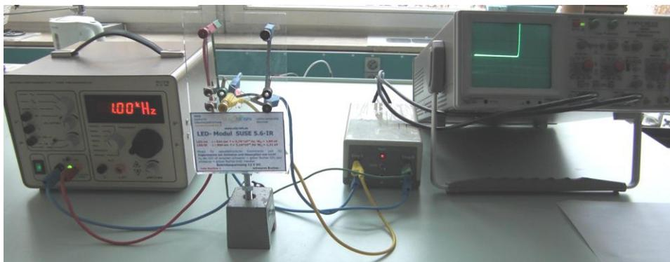
**Links:** Der Funktionsgenerator  $f = 1 \text{ kHz}$
