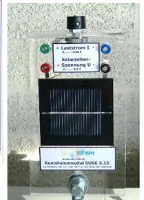
Mit dem Solarmodul SUSE 5.22 lassen sich umfangreiche Experimente zu den Eigenschaften und zur Funktion einer einzelnen Solarzelle durchführen, ebenso die Reihen- und Parallelschaltung von 2 Solarzellen. Wie auf dem Foto ersichtlich ist, können beide Solarzellen mit einem Verbindungsstecker (rückseitig) oder mit einem Schalter in Reihe geschaltet werden.
