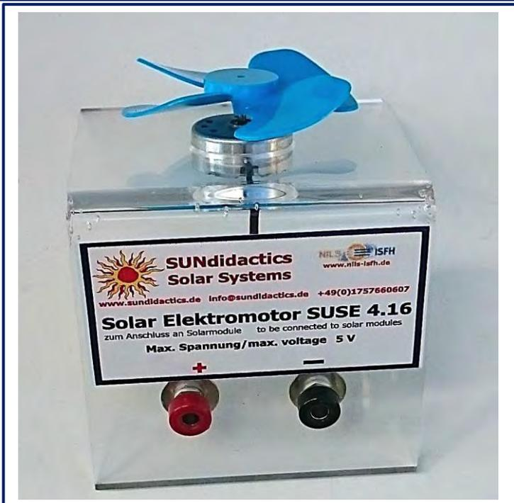
Das Solar- Motor- Modul SUSE 4.16 besteht aus einem Solar- Motor mit einem Propeller auf einem Plexiglasträger für den Betrieb an Gleichspannung von ca. 0,2V – max. 5,0V zum Anschluss an Solarzellen oder Solarmodule. Geeignet für Solar- Experimente in der Grundschule und der Sekundarstufe.
