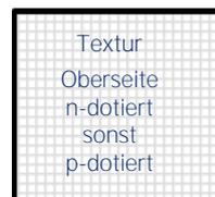
In einem Ofen strömt bei 900°C - 950°C Phosphoroxychlorid ( $\text{POCl}_3$ ) über die Oberfläche des Si- Wafers. Die [P]- Atome dringen in die Oberfläche ca. 0,2  $\mu\text{m}$  tief ein. Dort bildet sich der p-n-Übergang, der für die Ladungstrennung in der Solarzelle wichtig ist.
