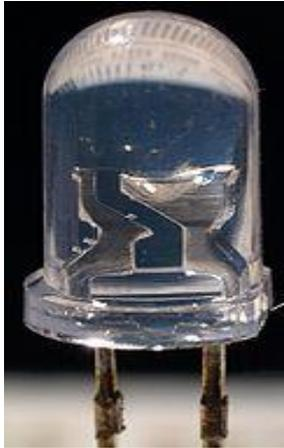
Foto einer LED: In einem transparenten Kunststoff-Gehäuse. Rechts befindet sich der Reflektor mit dem Halbleiterkristall, die obere Rundung des Gehäuses ist eine optische Linse. Der von der rechten Reflektorwanne abgehende Draht ist die Kathode. Der linke abgehende Kontakt ist die Anode, vom oberen Ende geht der sehr feine Bonddraht zur p-dotierten Zone des Halbleiterkristalls
