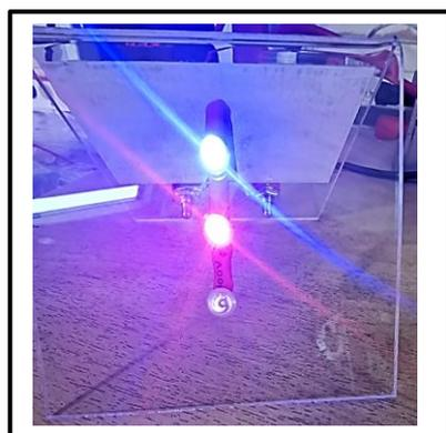
Hier leuchten alle 3 LEDs bei einer Spannung von 3 V (5 Solarzellen in Reihenschaltung) Das Licht der IR- LED kann man nicht mit bloßem Auge nicht sehen, die Kamera im Smartphone kann das IR- Licht aber aufnehmen und darstellen, man erkennt das am schwachen Leuchten der unteren IR- LED.
