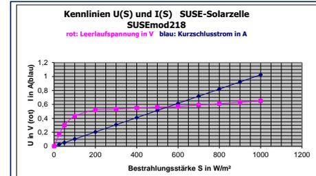
Die **Leerlaufspannung** (e- Funktion!) ist 0 bei totaler Dunkelheit, erhöht sich stark bei niedrigen Bestrahlungsstärken und wächst dann nur noch langsam bis zum Maximalwert 0,64 V bei 1000 W/m<sup>2</sup> (strahlender Sonnenschein bei blauem Himmel im Sommer, Solarzelle zur Sonne hin ausgerichtet).
