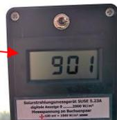
Das Solarmodul **SUSE 5.23A** ist ein **digital anzeigendes Messgerät zur Messung der Bestrahlungsstärke S des Sonnenlichts** oder des **Lichts von Lichtquellen** in der **internationalen Maßeinheit  $W/m^2$** .
