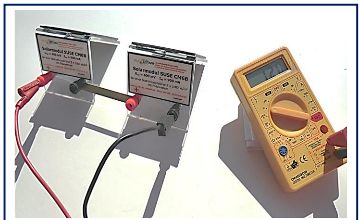
Oben: Das Solarmodul SUSE CM6B, links die Solarzelle SUSEmod218 Unten: 2 Geräte CM6B in Reihenschaltung mit Metallverbinder
