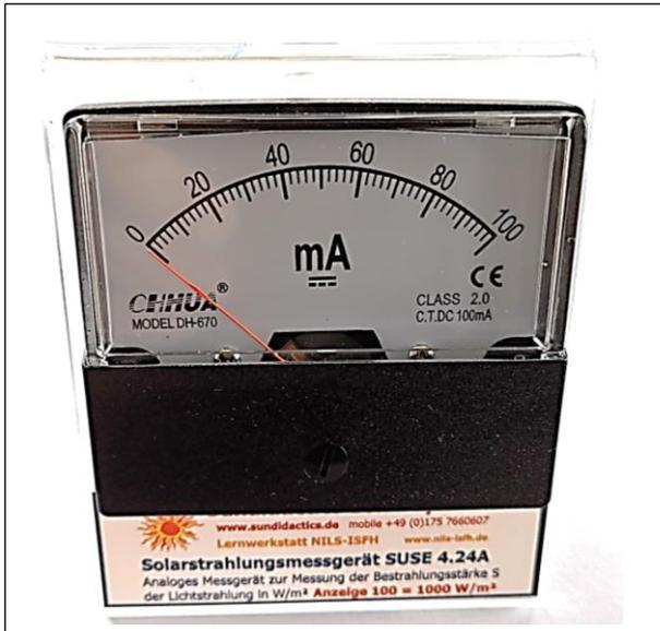
Das **Strahlungsmessgerät SUSE 4.24A**, auf der rechten Dachseite befindet sich die Solarzelle, auf der linken Dachseite das Anzeigegerät, ein 100-mA-Meter.
