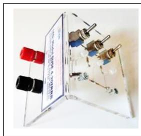
SUSE 4.20 LED Modul mit 3 LEDs
