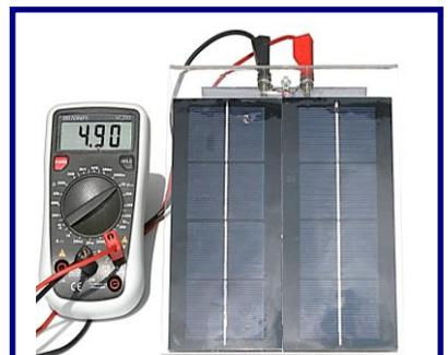
Das Solarfahrzeug 1.2 an der **Solartankstelle** (Solarmodul SUSE 4.35), ein Solarmodul mit 2,5V + 5,0V Ausgangsspannung, 8 Solarzellen in interner Reihenschaltung, ideal zum Laden des Solarfahrzeugs.
