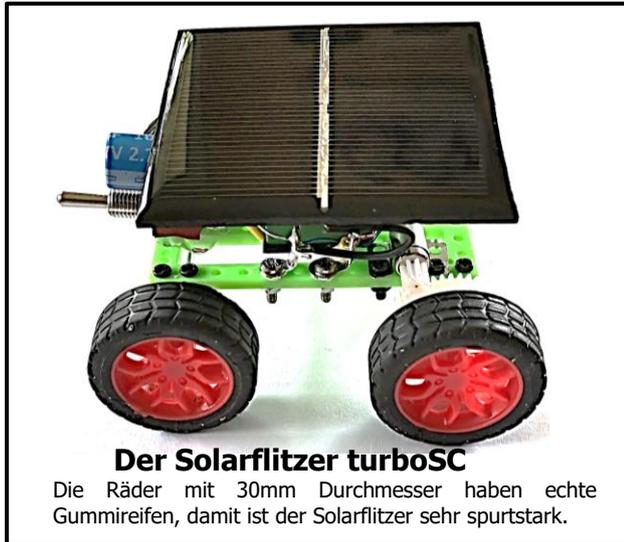
Auf dem Chassis des bewährten Solarfahrzeuges **SUSE Solarflitzer** befindet sich auf dem Distanzwürfel das Solarmodul mit 2 Solarzellen in integrierter Reihenschaltung ( $U_{oc} = 1,26 \text{ V} / I_{sc} = 480 \text{ mA}$ ). Links erkennt man den Betriebsschalter mit den 3 Positionen Laden-Aus-Fahren.
