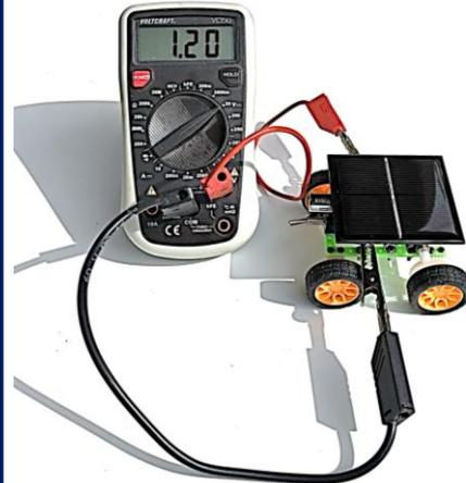
Messung der Ladespannung 1,20 V bei der Aufladung des Speicherkondensators im Sonnenlicht. Die Maximalspannung beträgt 1,26V.
