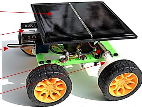
Die Räder mit 30mm Durchmesser haben einen Gummireifen, damit ist der Solarflitzer spurtstark, die Räder sind damit sehr griffig und halten die Spur.
