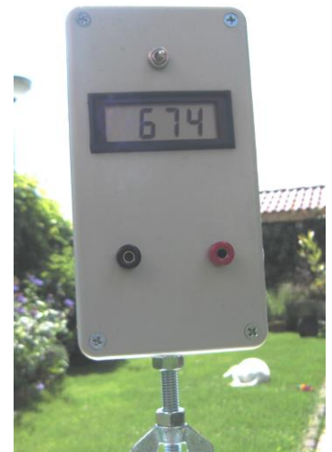
Bestrahlungsstärke S 674 W/m^2 an einem leicht bewölkten Tag
