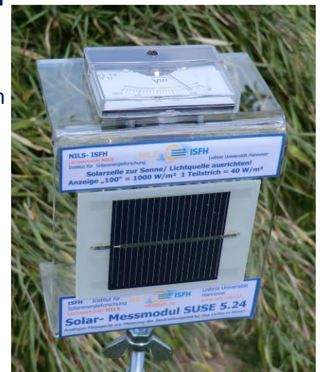
Bestrahlungsstärke S 674 W/m^2 an einem leicht bewölkten Tag
