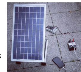
Laden eines Smartphones mit Solarmodul SUSE 4.42 (20 W) und Laderegler SUSE 4.17
