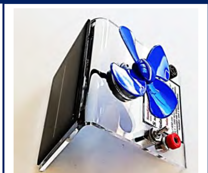
Oben: SUSE CM6MS, links die Solarzelle, rechts Buchsen, Schalter, Motor mit Propeller Unten: Messung der Leerlaufspannung im Sonnenlicht, 0,64V
