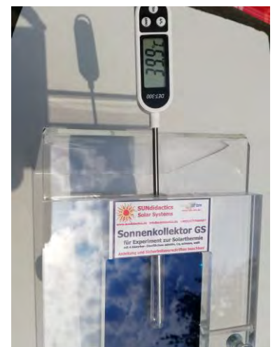
Foto 2 unten: Warmwasserbereitung, das Thermometer steckt im Reagenzglas und zeigt 39,9°C an.
