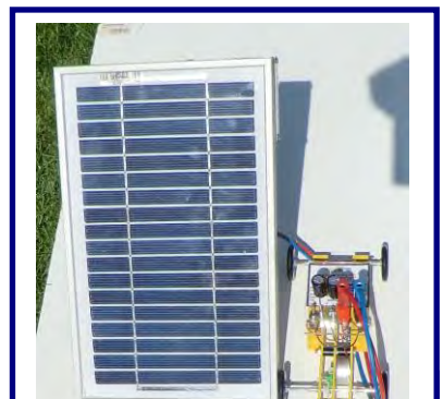
Solartankstelle (Solarmodul SUSE 4.49), ein Solarmodul mit 5,0 V Ausgangsspannung, ideal zum Laden des Solarfahrzeugs
