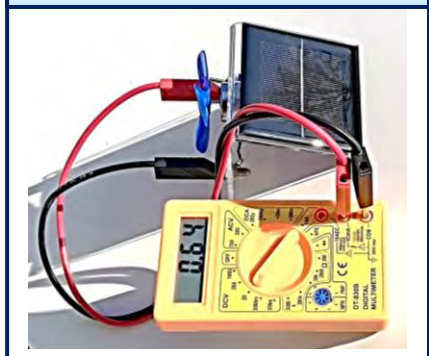
Oben: SUSE CM6MS, links die Solarzelle, rechts Buchsen, Schalter, Motor mit Propeller Unten: Messung der Leerlaufspannung im Sonnenlicht, 0,64V
