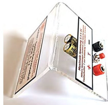
Oben: Das Speichermodul SUSE 4.12 Links die rote Buchse + , rechts die schwarze Buchse – zum Anschluss an ein Solarmodul. Der Tastschalter T in der Mitte dient zum Entladen.
