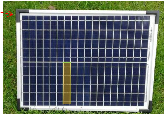
Vorderseite des Solarmoduls, gelb unterlegt ist 1 von 36 Solarzellen in 2 Reihen zu je 18
