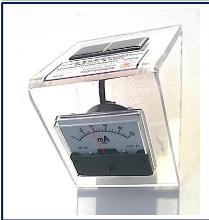
Das Strahlungsmessgerät SUSE 4.24A, auf der oberen Dachseite befindet sich die Solarzelle, auf der unteren Dachseite das Anzeigeinstrument, ein 100-mA-Meter.
