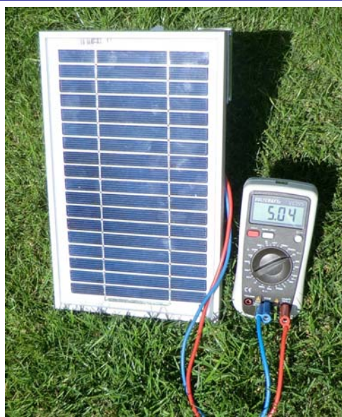
Das Solarmodul SUSE 4.50, am Multimeter wird die Ausgangsspannung am USB- Ausgang angezeigt.
